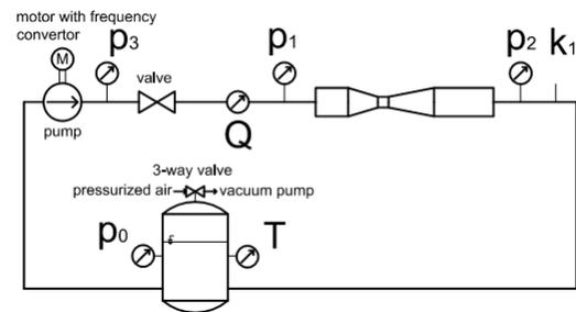
Fig. 2: Cavitation test rig
